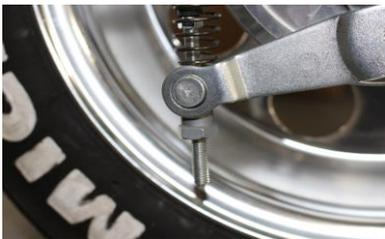
ブレーキの引きシロを確認し、ブレーキレバーを握りやすいようセッティングを行います。ドラムブレーキスプライン溝とアームの溝を差し替える作業を繰り返し行ってください。
