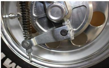
インジゲータープレートF&R共通をドラムシャフトへ取り付けした後、ロングブレーキアームをドラムシャフトへ差し込み、付属のフランジソケットM6×35 1ヶとフランジナットM6 1ヶを使用して確実に取り付けしてください。
