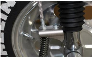
純正のブレーキケーブル、ブレーキアームをフォーク・ドラムブレーキ本体から取り外します。付属品のパワーブレーキストッパーステーをフォークへ取り付けします。フランジソケットM6×18 1ヶとフランジナットM6 1ヶを使用します。パワーブレーキストッパーステーはフォークステーの面に押し当てながら取り付けしてください。しっかり押し当てないと走行中にズれる場合があります危険です。
