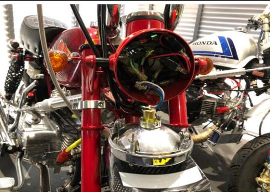
■小さいヘッドライトケースのため、ヘッドライトケース内部は配線類がゴチャゴチャになってしまいます。アクセサリ電源等をご使用いただくことで、ヘッドライトケース内部の配線と配線が交差してしまい、場合によってはショートの原因や電線から発せられる放射熱の影響で各部品に悪影響を及ぼすことがあります。
