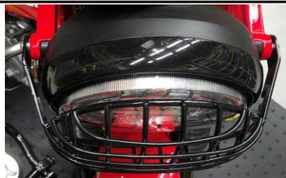
3.上部のイメージです。左右ステー、ガード枠がヘッドライト本体と干渉していないことを確認してください。
