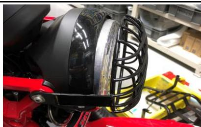
2.ヘッドライトステーとヘッドライトが一定の隙間となるよう、調整した上でボタンボルトM6×30を本締めしてください。
