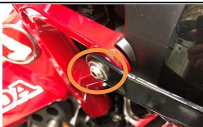
1.純正のヘッドライト左右ボルトM6×17 2ヶを取り外します。キットに付属のスペーサー2ヶをヘッドライトステーのくぼみに入れ、ヘッドライトステー、平ワッシャーの順に重ねます。付属のボタンボルトM6×30を使用して左右共に仮固定します。走行中にネジが緩み、ライトガードでヘッドライトが疵付かないよう、ネジ緩み止め材を塗布することをお薦めします。
