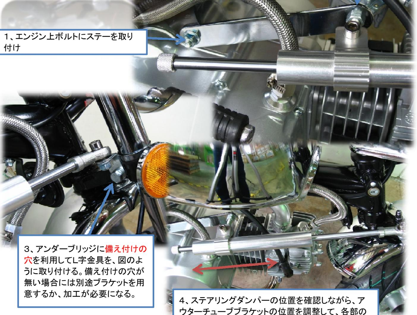
3、アンダーブリッジに備え付けの穴を利用してL字金具を、図のように取り付ける。備え付けの穴が無い場合には別途ブラケットを用意するか、加工が必要になる。
