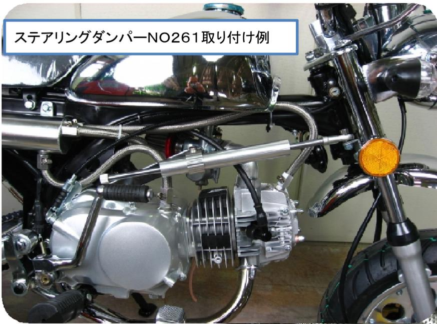
2、ステアリングダンパー側ステーとプレートステーをボルト留めする
